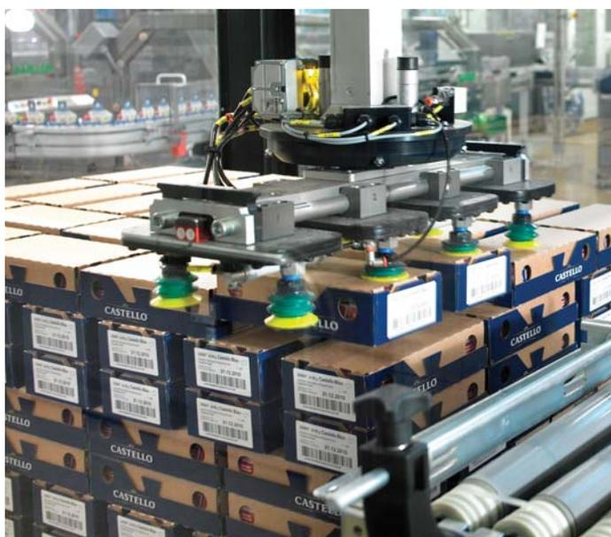
*Le préhenseur multifonctionnel spécial attrape jusqu'à 4 cartons à la fois et les place sur la palette en les espaçant pour permettre qu'ils refroidissent correctement pendant leur stockage.*
