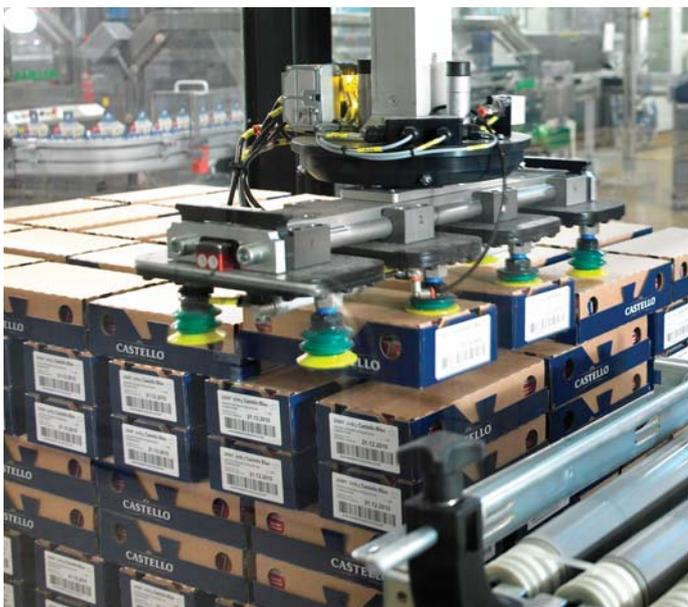
*Der spezielle Multifunktion-Greifer holt bis zu 4 Kartons auf einmal und platziert sie auf die Palette mit Abstand zur Sicherung der korrekten Kühlung im Lagerhaus.*
