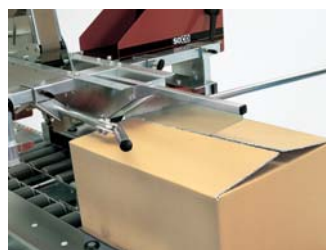
Der Karton wird auf der Schiene abgesetzt und zum Endanschlag geschoben, Längsklappen werden automatisch eingefaltet.
