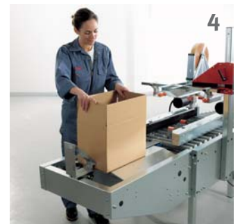
La caja se mantiene en su lugar y está preparada para ser rellena.
