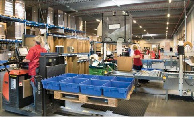
**Der Wechsel von Handabrollern zu Kartonverschließern führte zu einer verbesserten Ergonomie und einer 20-30% Kapazitätserhöhung**
