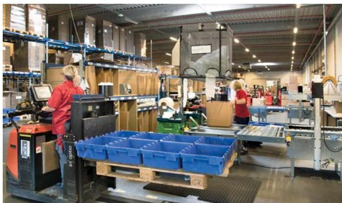
**La passage de scotcheuses manuelles à des fermeuses de carton a donné lieu à une amélioration de l'ergonomie et à une augmentation de capacité de 20 à 30 %.**
