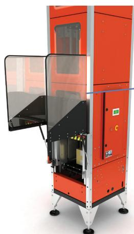
L'accès sécurisé permet d'accéder à l'entrée de la machine. La machine ne peut être remise en marche que si le tunnel d'accès est refermé.
