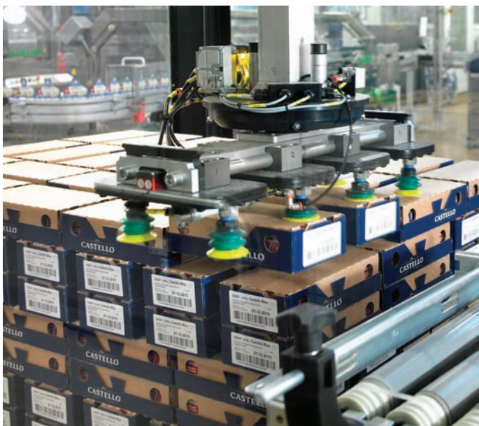
Det særlige multifunktions gribehoved henter op til 4 kartoner ad gangen og placerer dem på pallen med mellemrum, der sikrer den korrekte køling under opbevaring.
